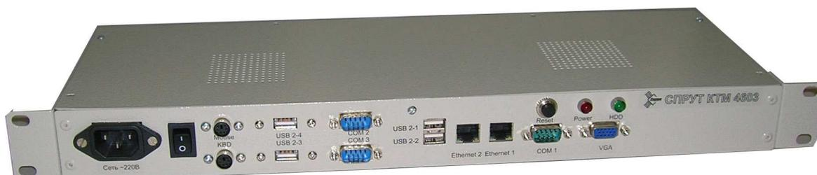
Рисунок 2. Расположение и условные обозначения разъемов наружной панели корпуса контроллера
