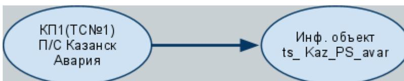
Таким образом при обработке приходящих с КП телемеханических данных на шине создается модель данных объекта управления с уникальным именем, определенным в файле конфигурации данных. Значение сигнала/параметра передается в модель с учетом формулы входного преобразования.
