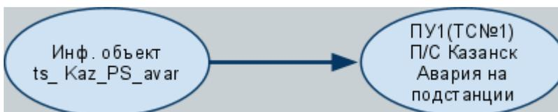
Текущее значение сигнала/параметра модели данных привязывается к выходному телемеханическому адресу и передается в выходной канал (с учетом формулы выходного преобразования) на ПУ1 (ТС №1).
